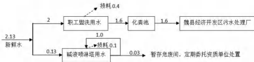
图2-1本工程给排水平衡图 (m³/d)
