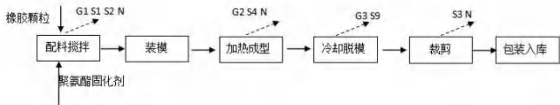
图 2-4 营运期橡胶地垫片材生产工艺流程及产污环节图
